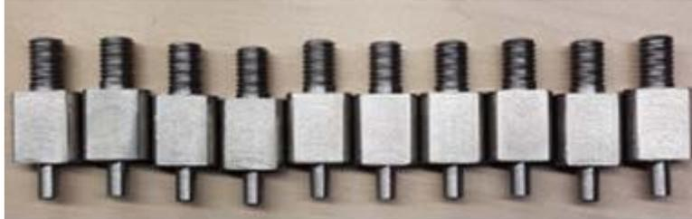
Figura 49 – Acoples Mecánicos (Machón) 8mm
