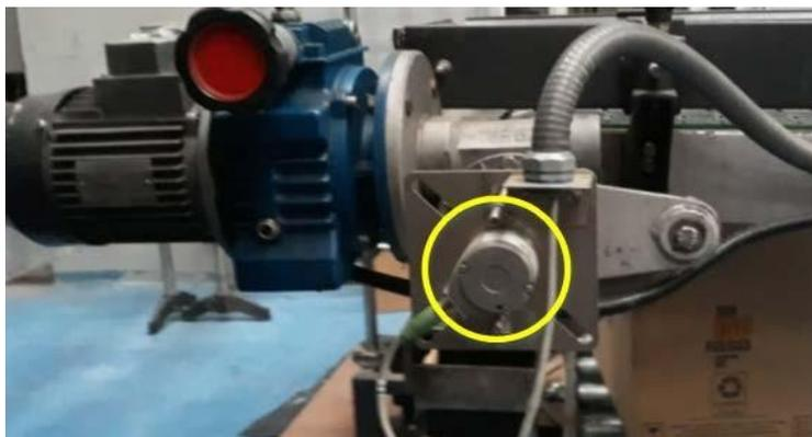
Figura 9 – Ilustración del Encoder instalado
