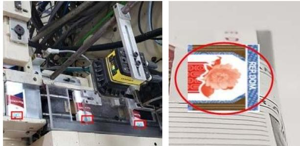
2. Será obligatorio que el operador de línea de producción alimente los MCF en el aplicador de etiquetas con los mismos (MCF) con la cara para arriba y el mapa de República Dominicana en el lado derecho de la tolva de alimentación del etiquetador, como se muestra en la siguiente ilustración:
