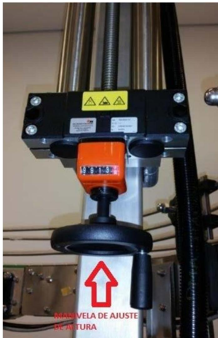
*Figura 81. Ajuste de altura de sistema BEAM.*
