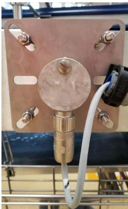
*Figura 41 – Ilustración del Encoder instalado*
